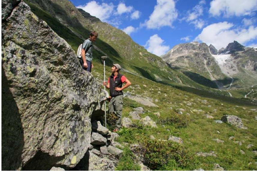
Abb. 7: Vermessung mittels Differential-GPS in Kooperation mit der ETH Zürich (Foto: Th. Reitmaier)
