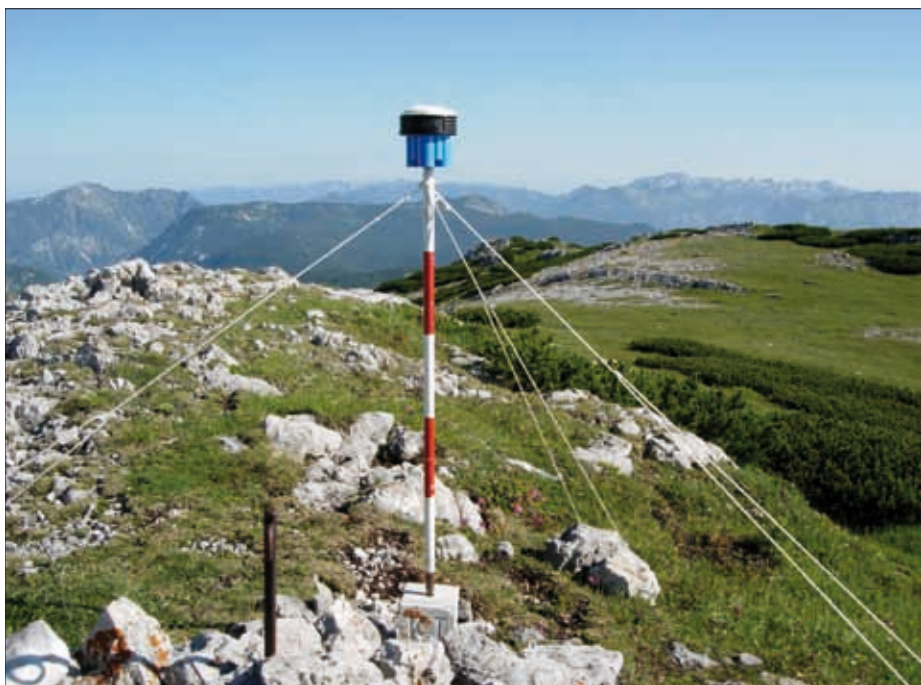
Abb. 5: Aufstellung mittels Lotstab
